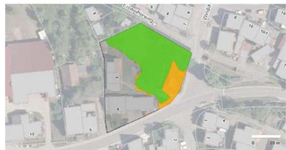
Die Datengrundlage bildet das Geländemodell (sog. HYD-DGM) und die Wasserspiegellagen der Hochwassergefahrenkarte beides als 0,5m Werteraster. Das Höhenbezugssystem ist DHHN2016, Höhenstatus (HST) 170, EPSG 7837.
