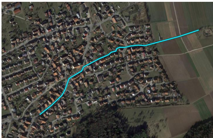
Abbildung 36: Ausschnitt Abwasserkanal Oberndorf \geq DN 800 (eigene Darstellung mit GIS)
