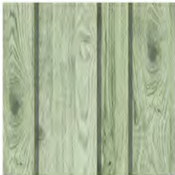
Fassade / Holzschalung Fichte, grün lasiert
