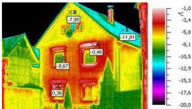
Abb. V-1 Thermobildverfahren/ Schwachstellenanalyse
